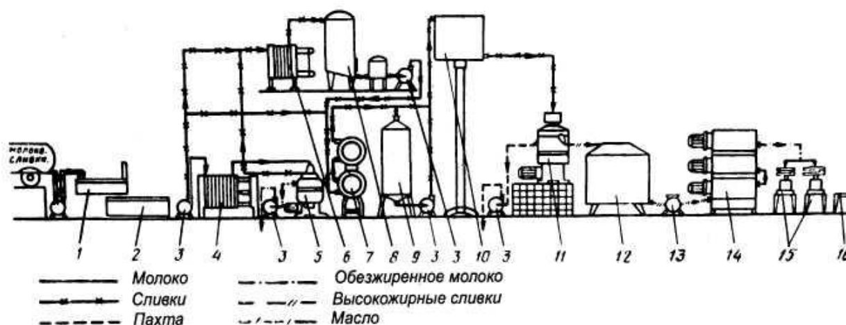
Рисунок 10.5 Схема технологического процесса производства сливочного масла методом преобразования высокожирных сливок.
