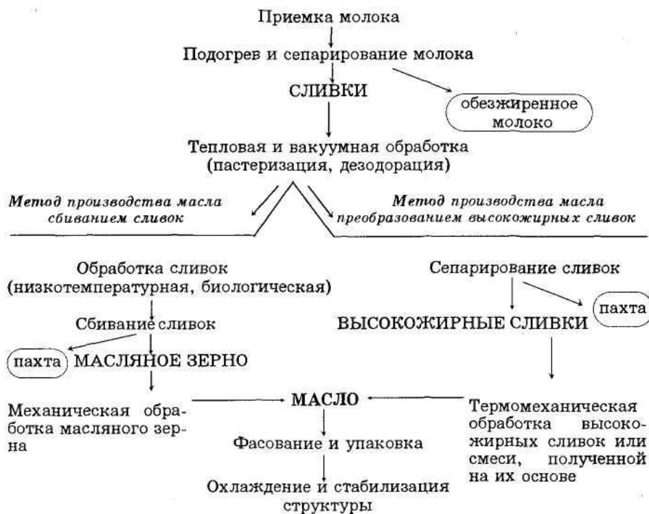
Рис. 7.1. Схема выработки сливочного масла различными методами
